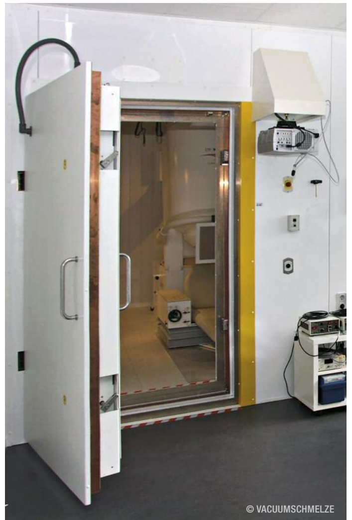
➤ MSR通常约为4米x 4米，足以容纳相对较大的设备。这里有一个投影仪（门的右上方）显示图像。脑磁图（MEG）检测受试者大脑神经元的活动，作为观看图像的反应
